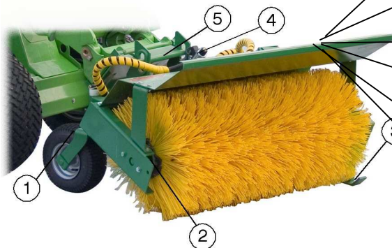
Harjalaitteen pääkomponentit sekä varoitusmerkintöjen sijainnit
